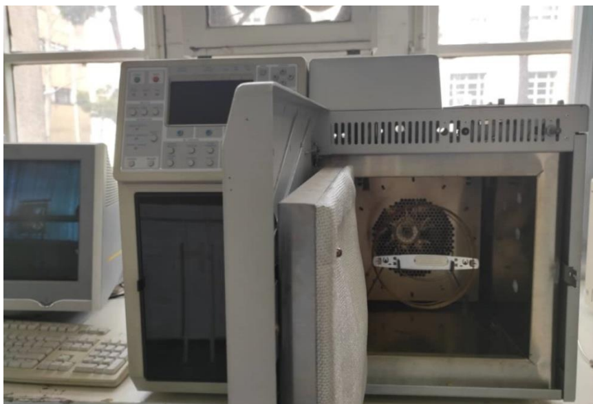
شکل ۱۱- دستگاه گاز کروماتوگراف Varian CP-3800
