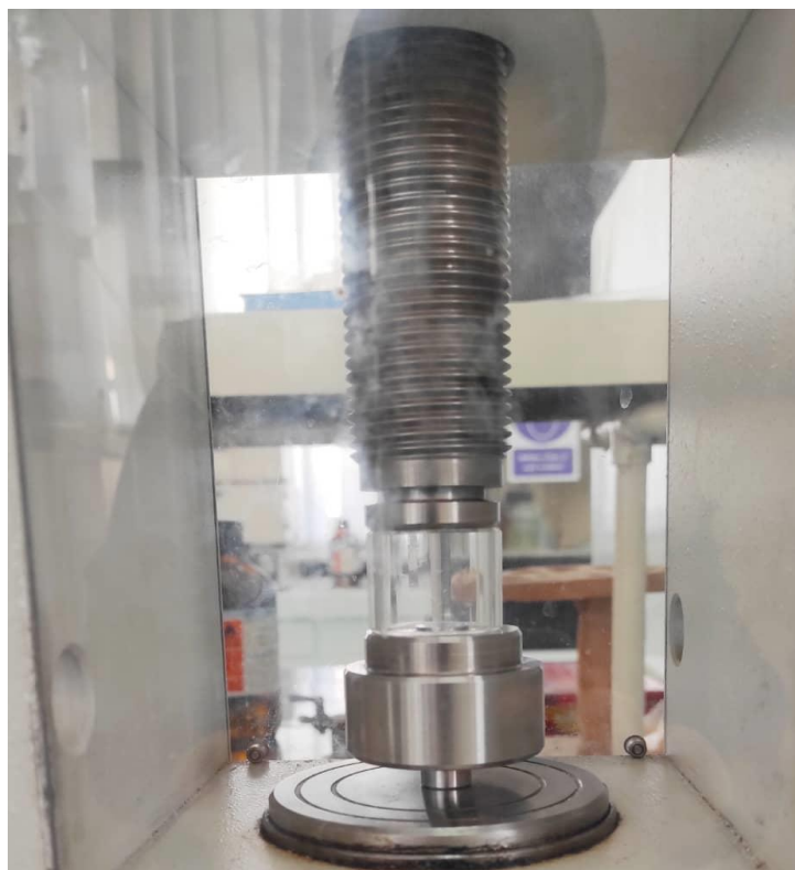
شکل ۳۳- بیرون آوردن قرص از سیلندر با استفاده از استوانه توخالی و ایجاد خلأ
