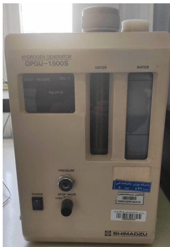
شکل ۱۴- مولد هیدروژن دستگاه GC
