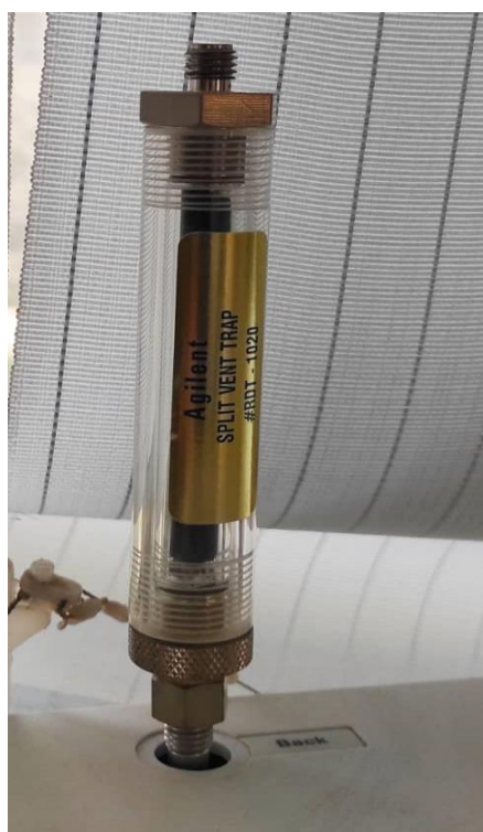
شکل ۵- فیلتر زغالی برای جذب گازهای خروجی از اینلت دستگاه
