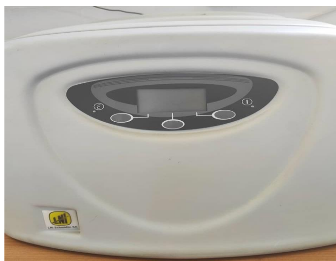
شکل ۸- مولد نیتروژن دستگاه GC
