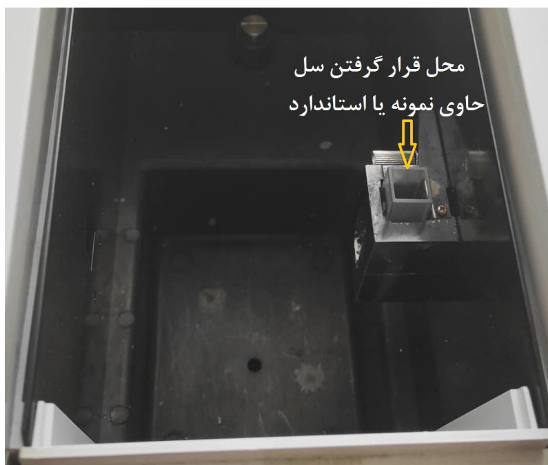
شکل ۳۸- محل قرار گرفتن کووت حاوی نمونه / استاندارد
