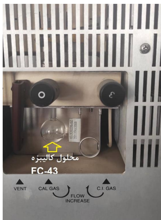
شکل ۱۸- محلول کالیبره مخصوص GC-MS
