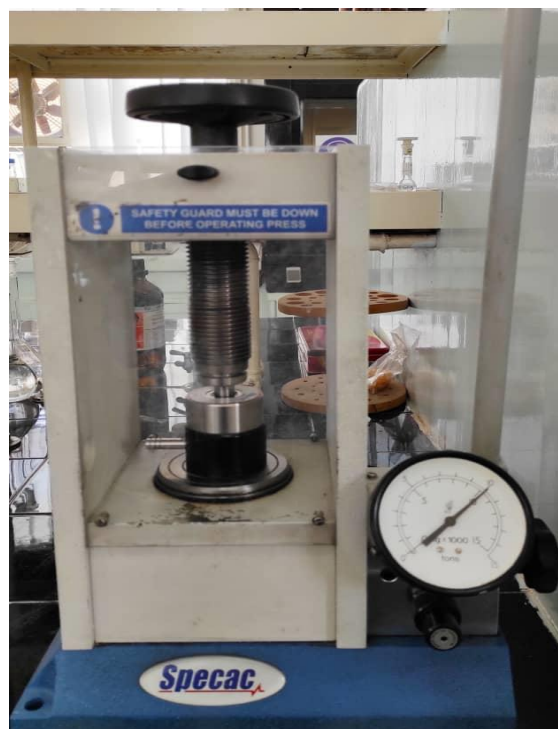
شکل ۳۲- پرس کردن نمونه تا فشار ۱۰ تن با پرس هیدرولیک
