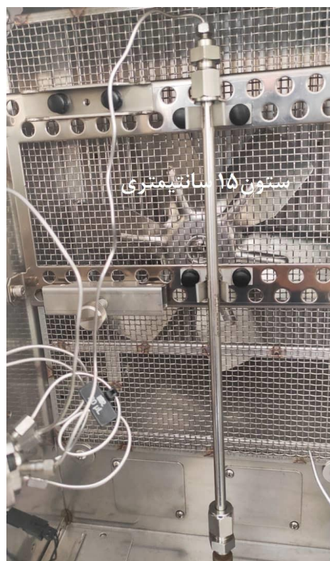
شکل ۲۴- ستون نصب شده در آون دستگاه HPLC
